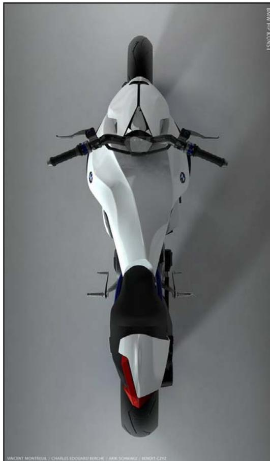
La HP Kunst de BMW posee un motor eléctrico con una potencia final bastante contenida de 136 CV alimentado por celdas de combustible y una batería con iones de litio. El depósito de combustible es criogénico y puede alojar hasta 20 litros de hidrógeno, habiendo optado la marca por el uso de hidrógeno líquido como ya ha dejado expuesto en el diseño de varios modelos de automóviles. Sin dudas es la motocicleta más ecológica de BMW y también la de tecnología más limpia del mercado.
